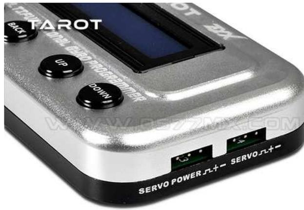
SERVO POWER เมื่อต้องการทดสอบเซอร์โว เสียบสายนำไฟมาจากเครื่องรับวิทยุ (หรือใช้แหล่งจ่ายอื่นที่มีระดับแรงดันที่ใช้งานได้) และต้องตรวจสอบระดับแรงดันไฟจากแบตเตอรี่ว่าจะไม่ทำให้เซอร์โวเสียหาย
